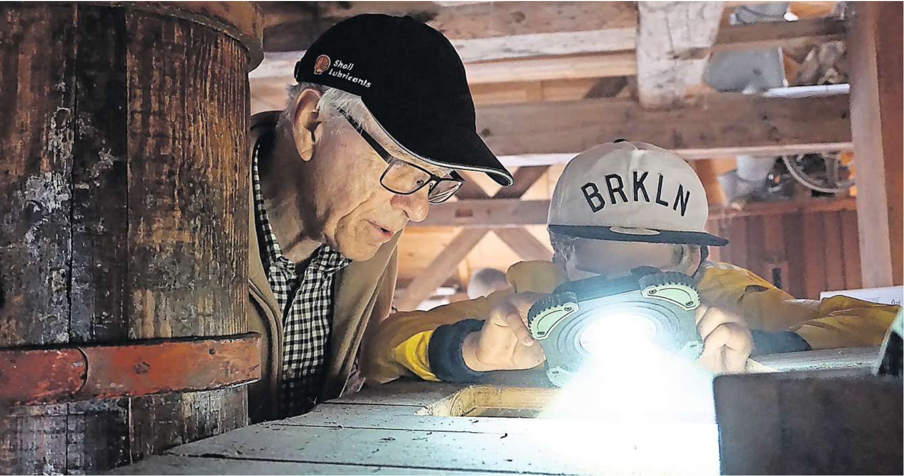
Mit der Taschenlampe leuchtete Arthur in den Behälter über dem Mahlwerk, um zu sehen, wie viel Getreide bereits dort hinein transportiert wurde. Der Götzberger Mühlenführer Klaus Guth schaute mit. FOTOS: NICOLE SCHOLMANN
