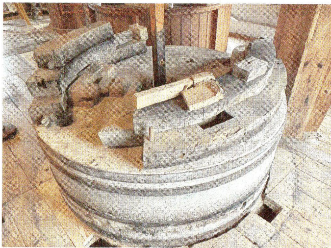
Der Mahlgang vor der Reparatur...
