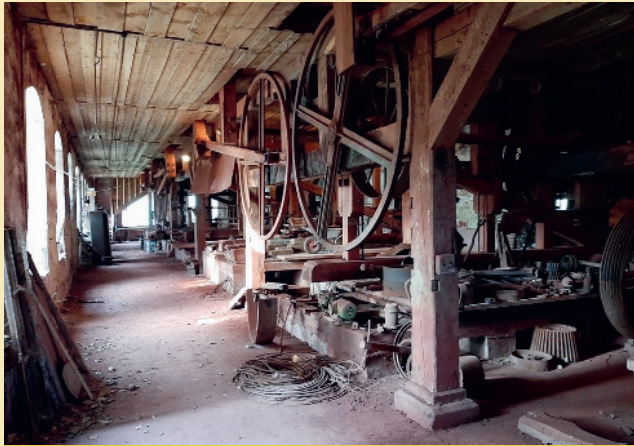
Ursprünglich als Hammerwerk und Mühle genutzt, wurde die „Alte Schleif“ in Münchshofen (Bayern) 1890 zur Glaschleife umgebaut. Bis 1953 liefen hier, von gewaltigen Wasserrädern angetrieben, rund um die Uhr auf zwei Stockwerken die hölzernen Poliertische. Foto: Matthias Haberl, Teublitz
