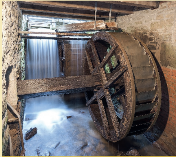
Aufgebaut auf den Resten eines alten Eisenhammers, wurde die Papiermühle Plöger (Lippe, NRW) 1697 erbaut und nutzte mit ihren beiden überschlächtigen Wasserrädern fast 300 Jahre das weiche Wasser der Niese zur Papier- und Aktendeckelherstellung. Foto: Heimatverein Schieder e.V.
